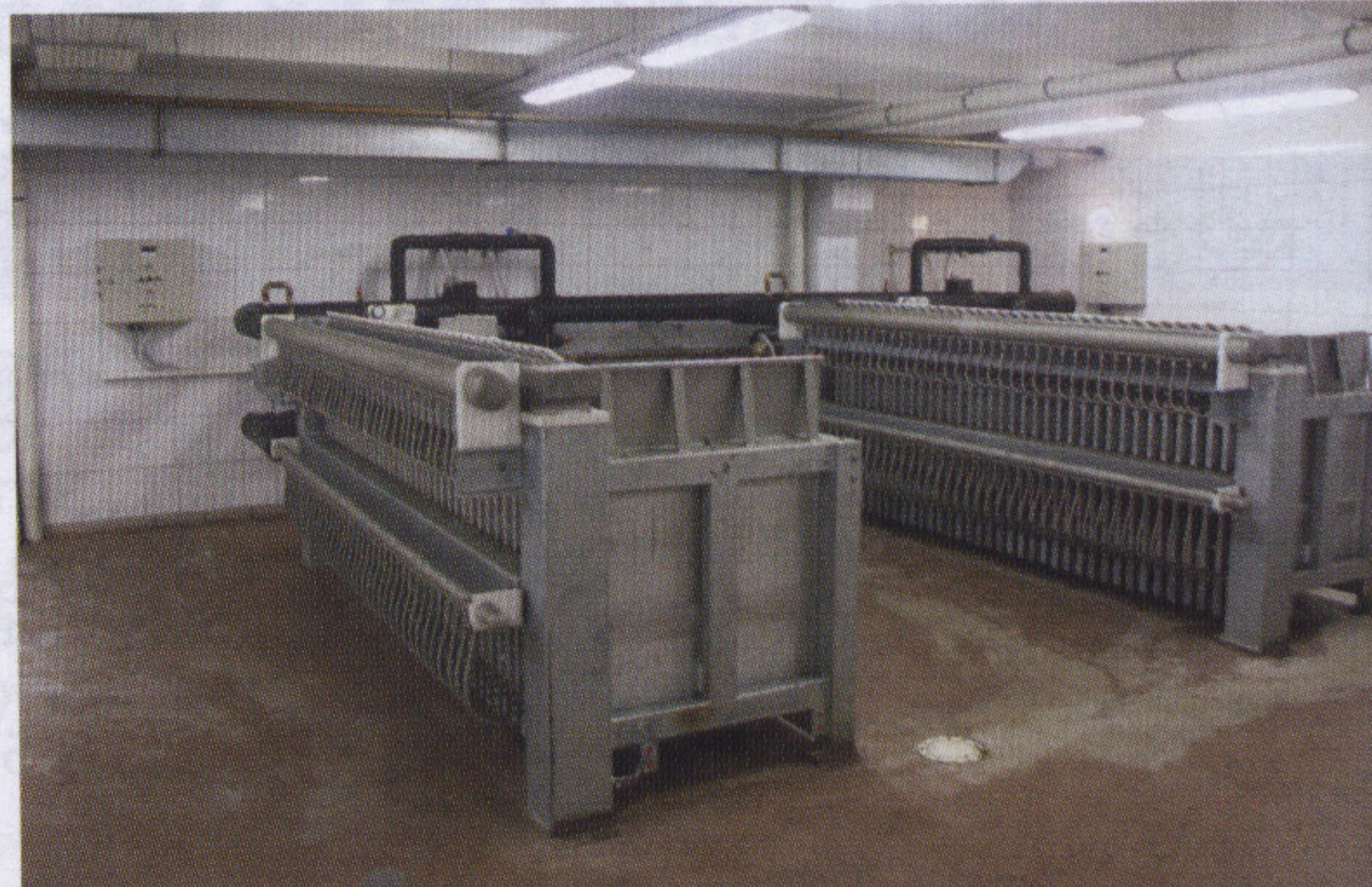
Помещение для замораживания мясопродуктов двумя скороморозильными аппаратами общей производительностью 25 т/сут.
