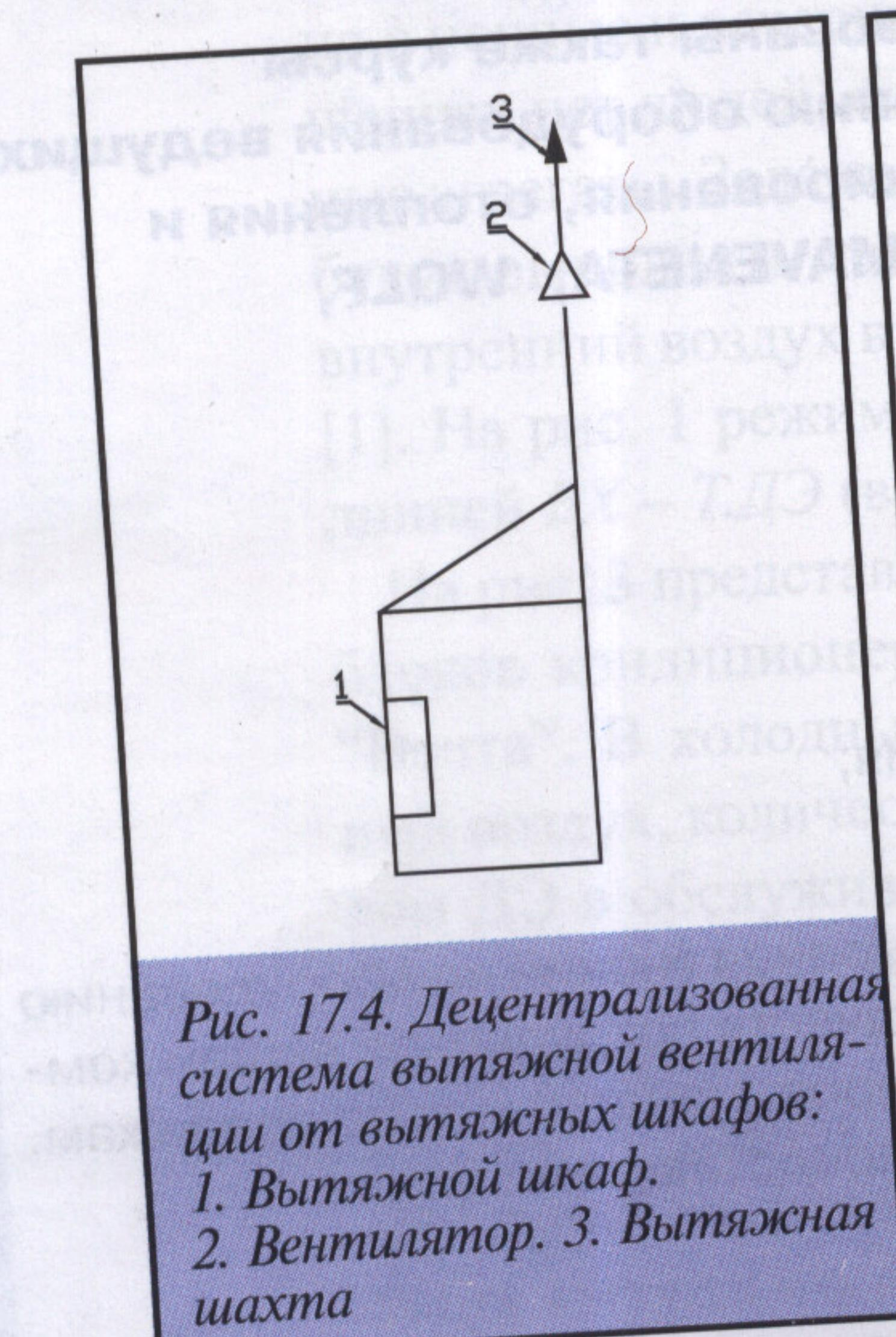
Рис. 17.4. Децентрализованная система вытяжной вентиляции от вытяжных шкафов:
