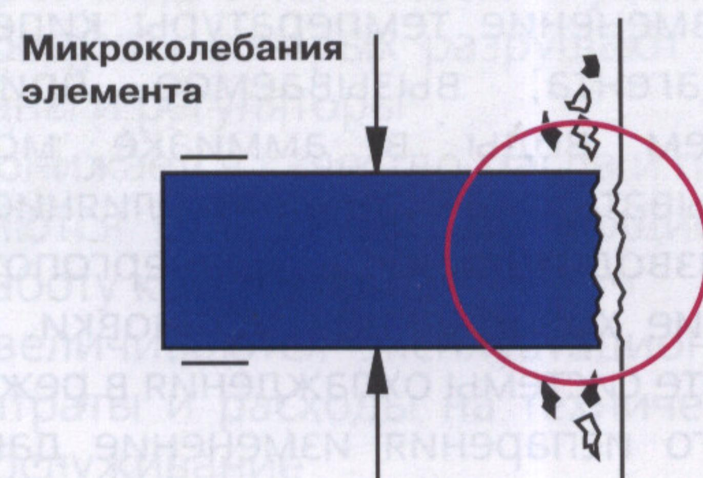
Рис. 3. Проблемы в работе вентилей и механических регуляторов, связанные с проникновением воды в систему
