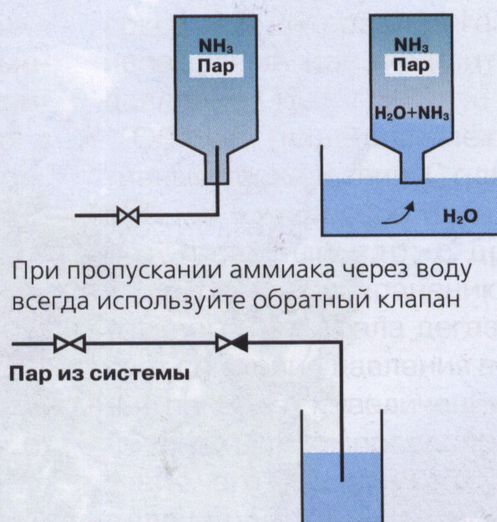
При пропускании аммиака через воду всегда используйте обратный клапан
