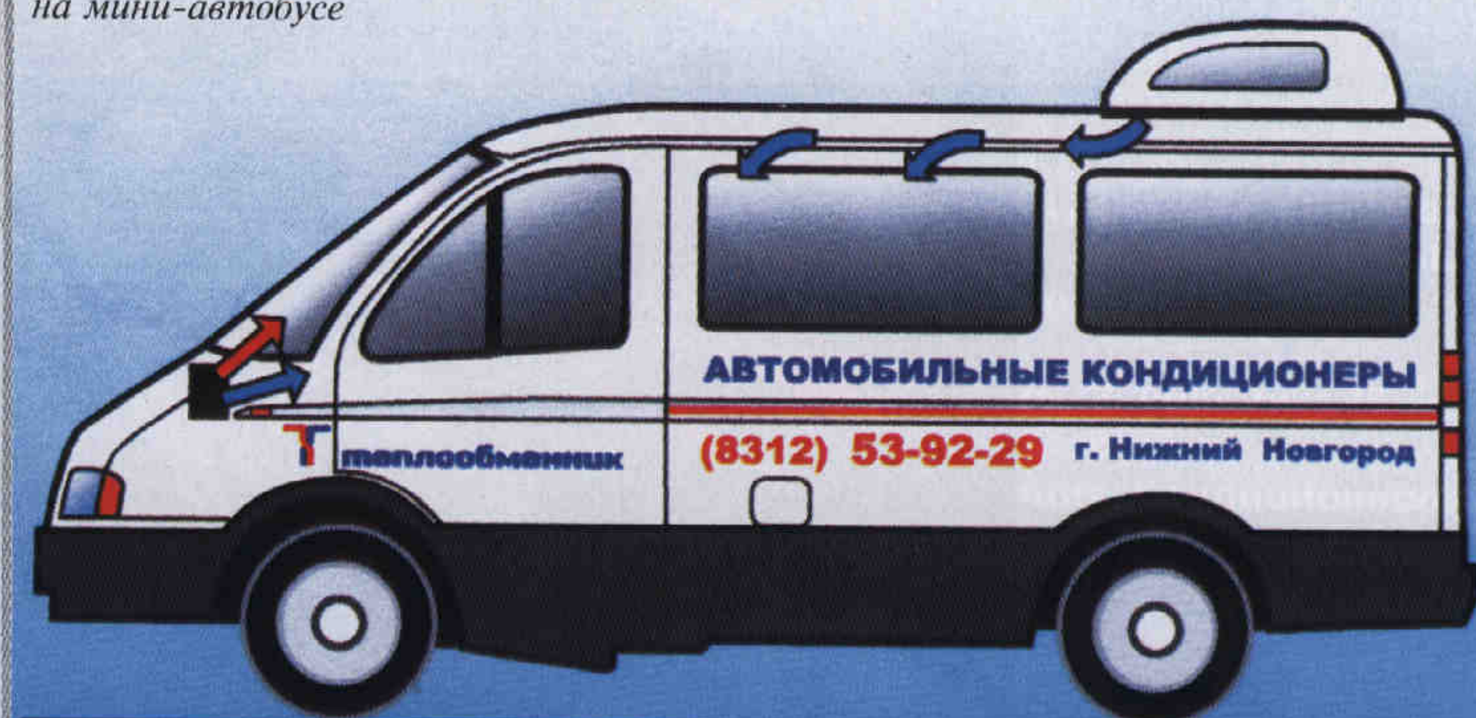
Рис. 1. Схема установки двухблочного кондиционера на мини-автобусе
