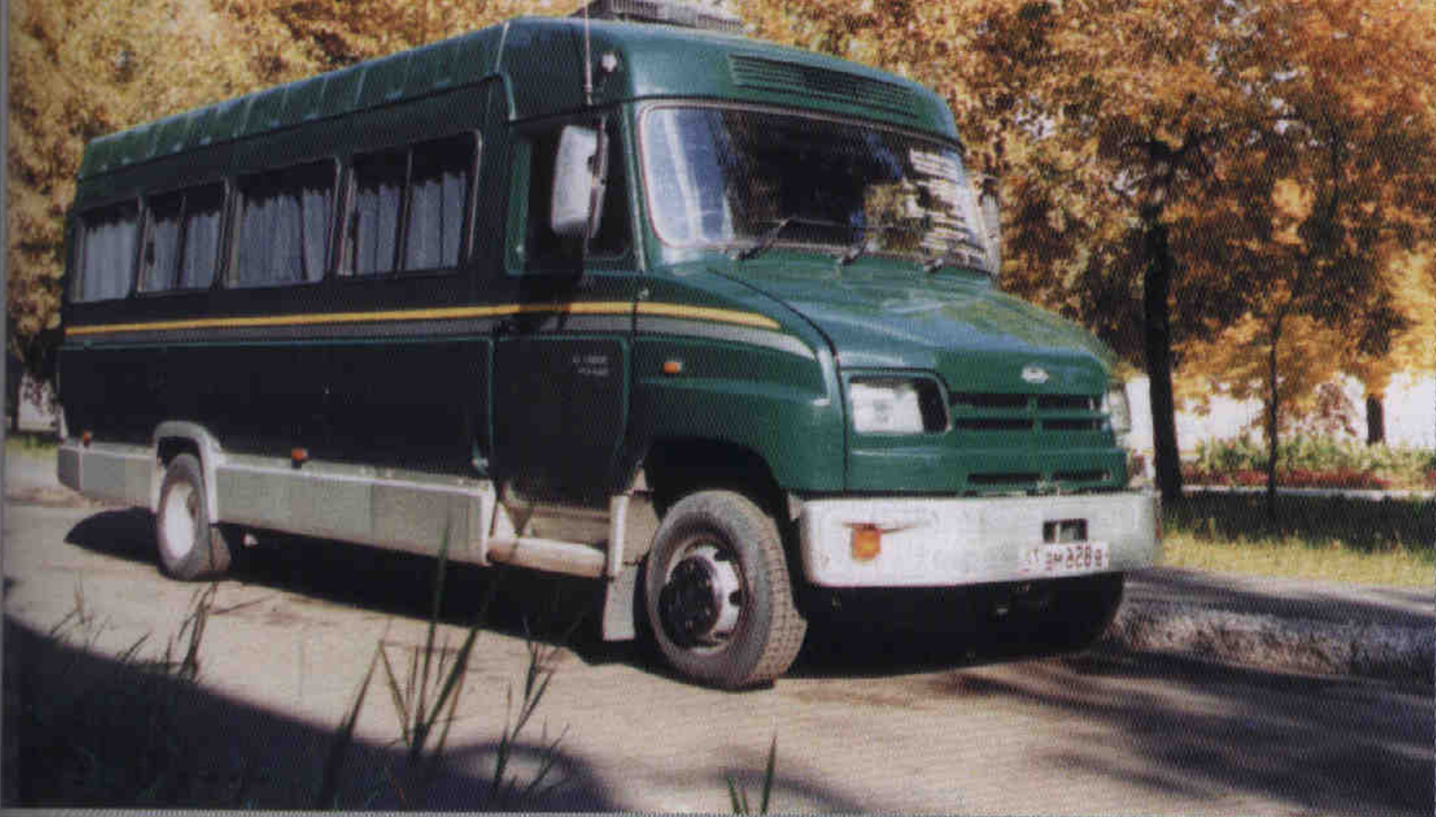
Рис. 2. Туристический автобус повышенной комфортабельности «ЗИЛ-325000-12» с импортным кондиционером, термоэлектрическим холодильником 50 л и туалетной комнатой
