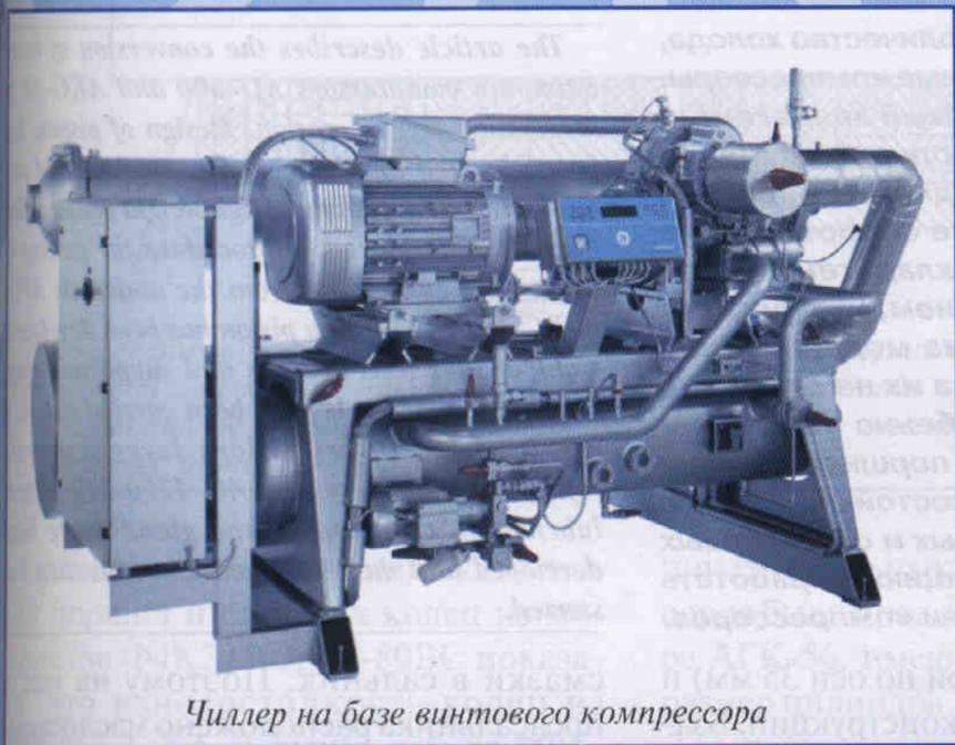
Чиллер на базе винтового компрессора
