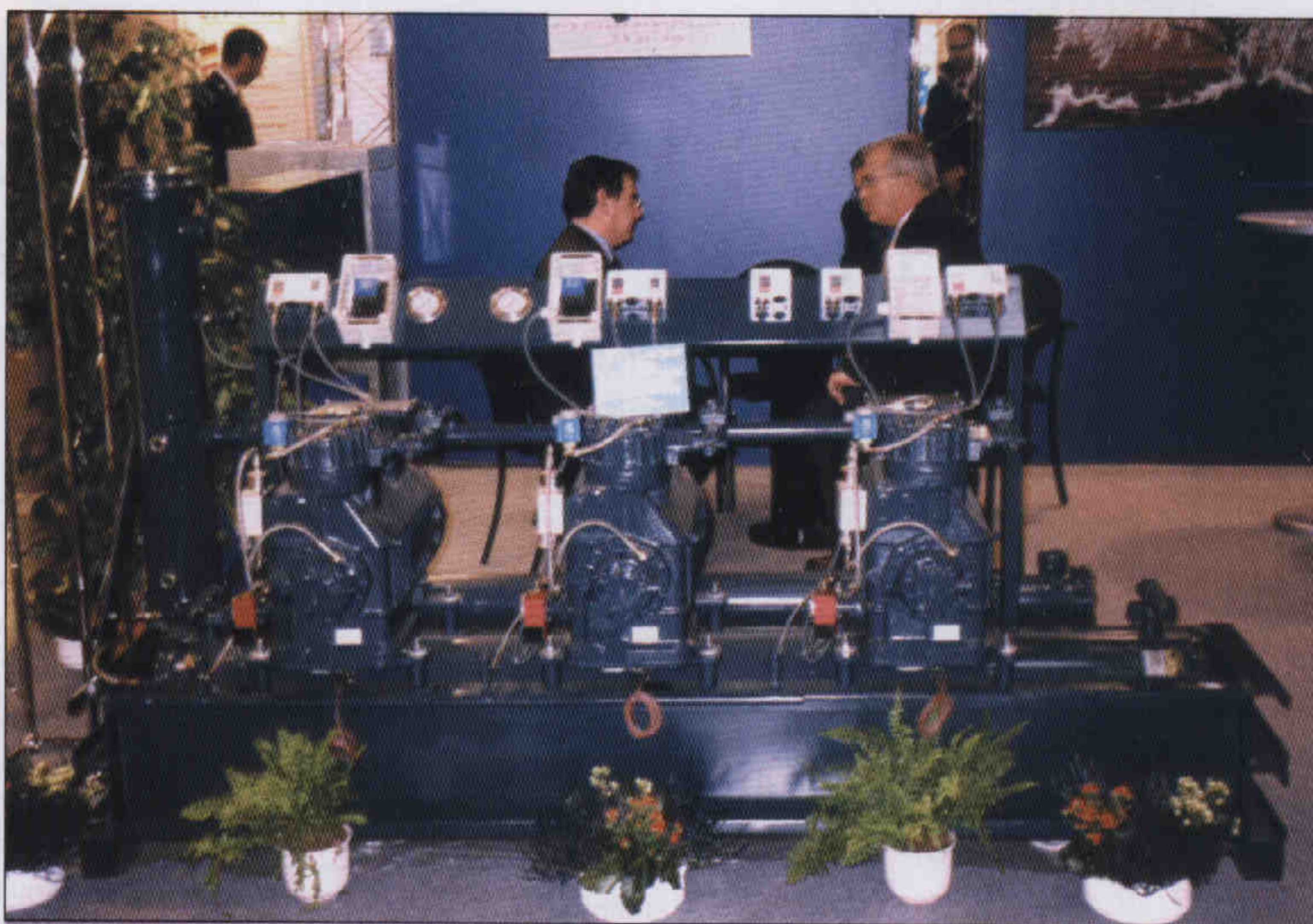
Трехкомпрессорная централь с системой отделения и выравнивания давлений масла
