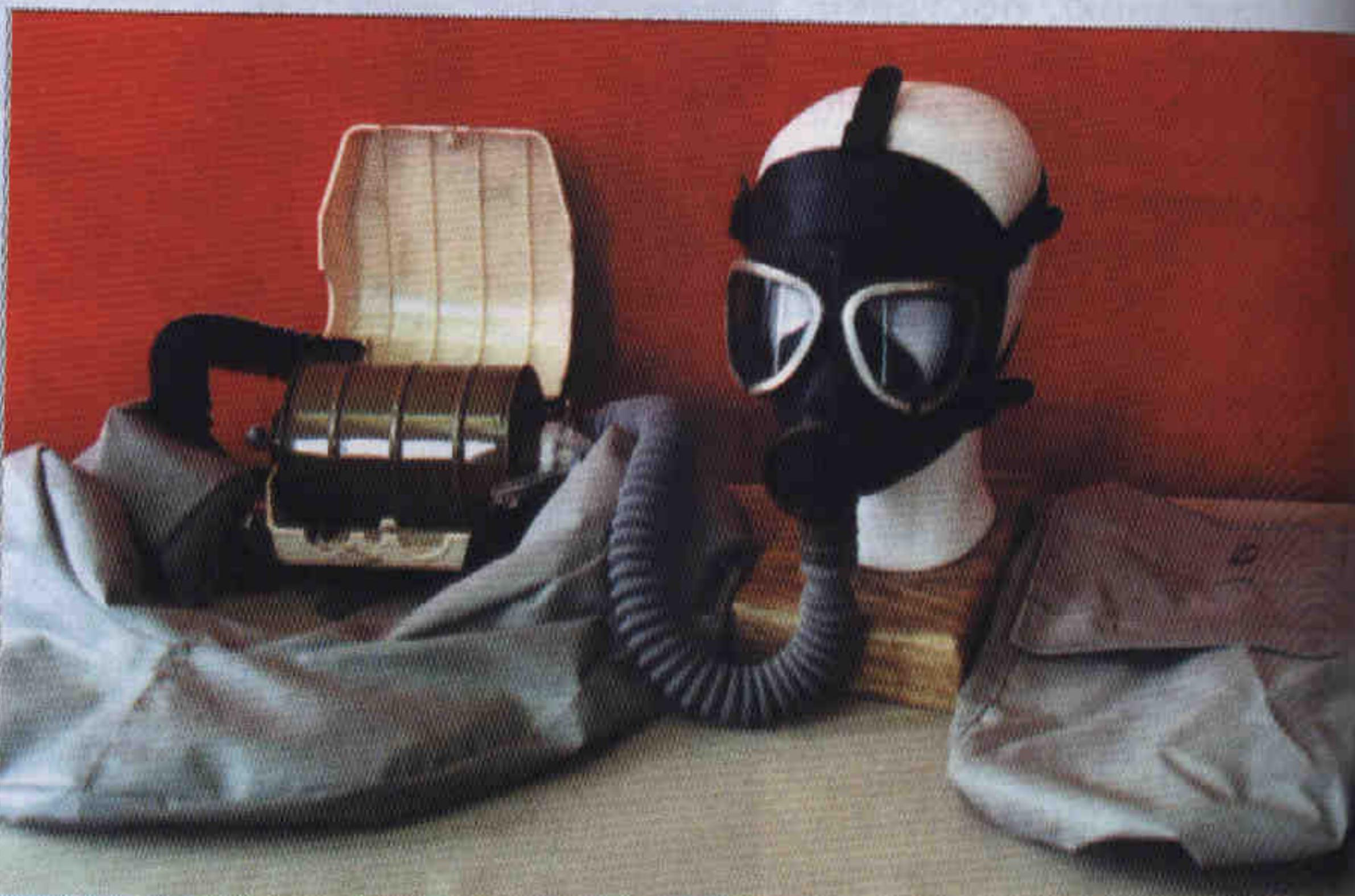
образного аммиака при концентрации, не превышающей 10–15 ПДК (ПДК = 20 мг/м<sup>3</sup>), используют противогазовый респиратор РПГ-67 и универсальный РУ-60м в комплекте с патронами (КД). Последний одновременно защищает от вредных аэрозолей при концентрации до 100 мг/м<sup>3</sup>.
