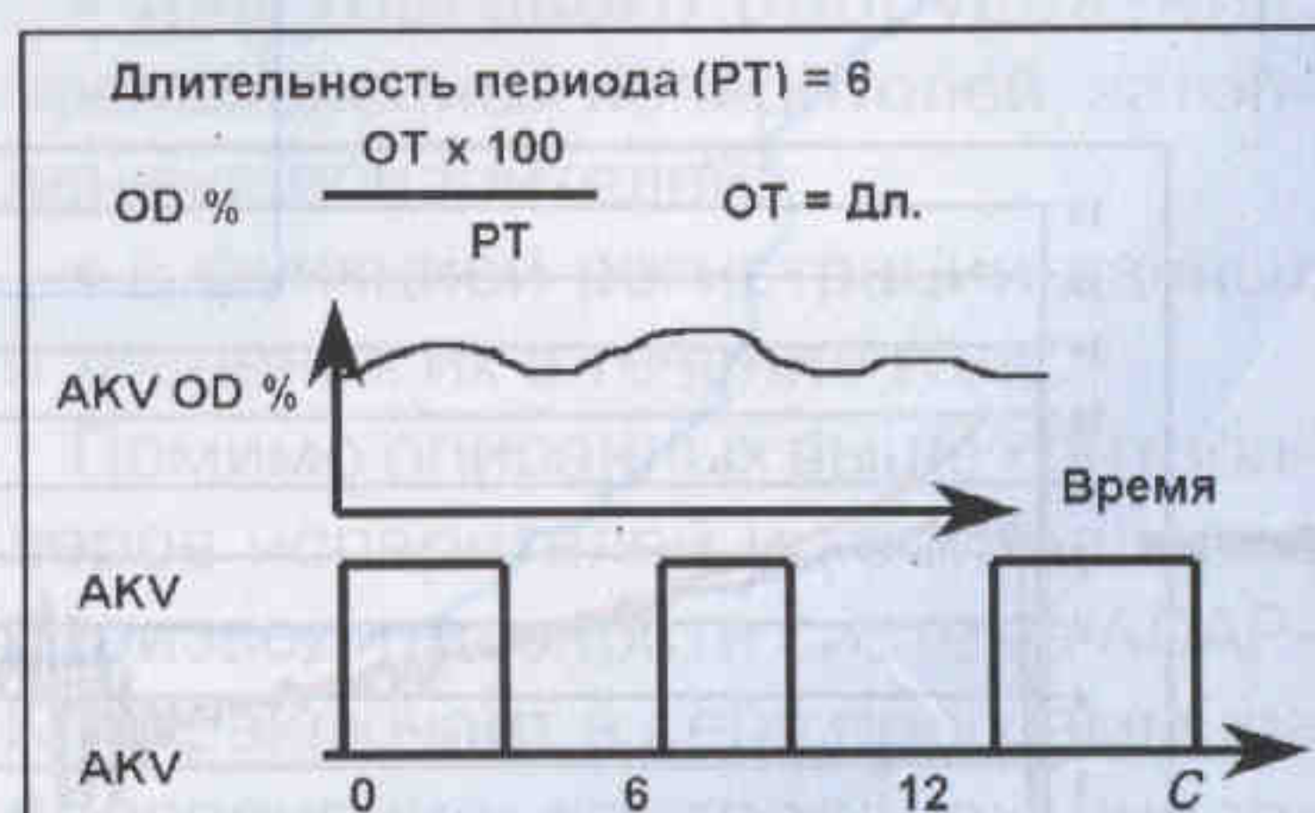
Рис. 2. Работа импульсного расширительного вентиля AKV на принципе пульсирующей модуляции
