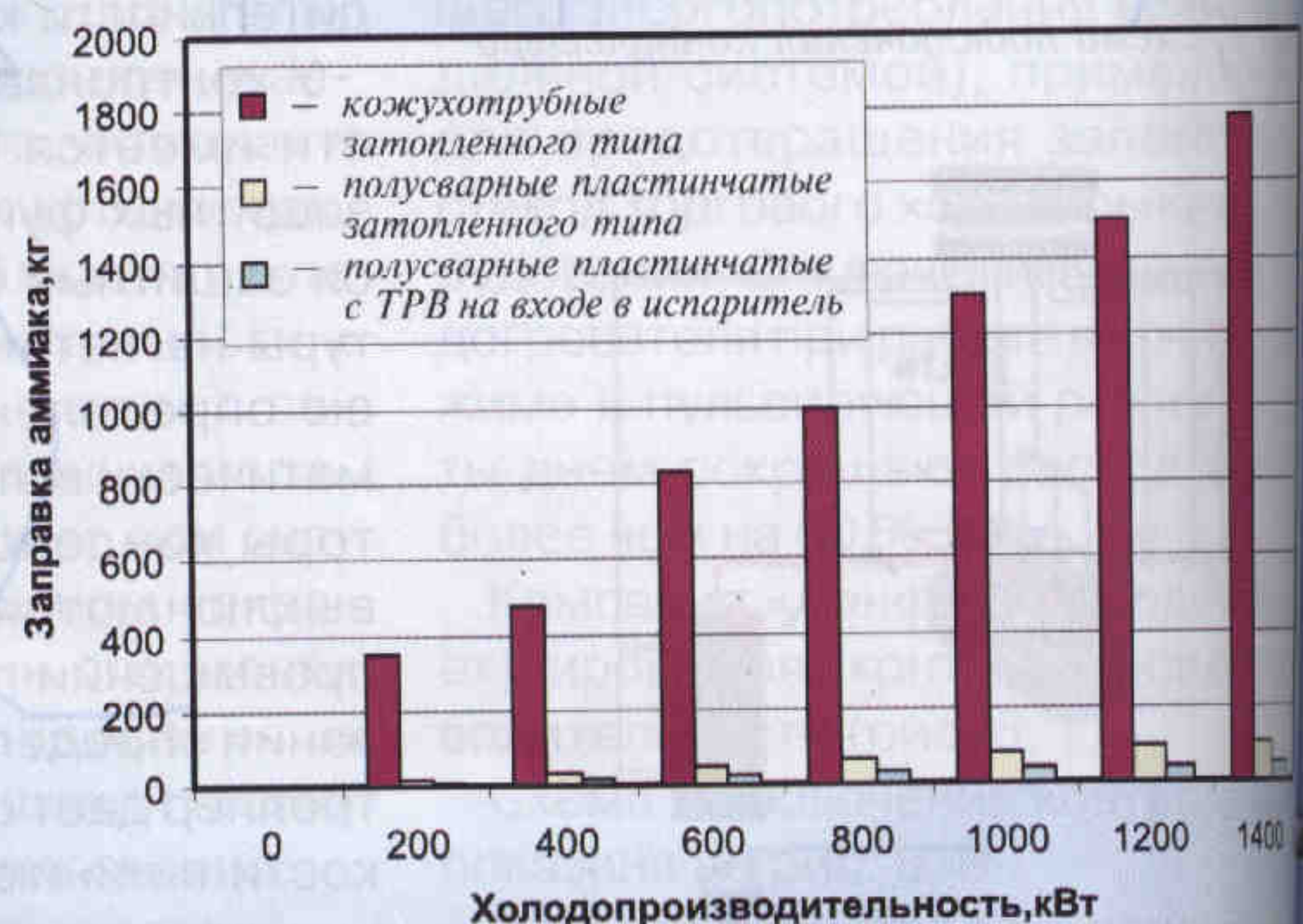
Рис. 1. Сравнение различных типов теплообменников по заправке аммиаком
