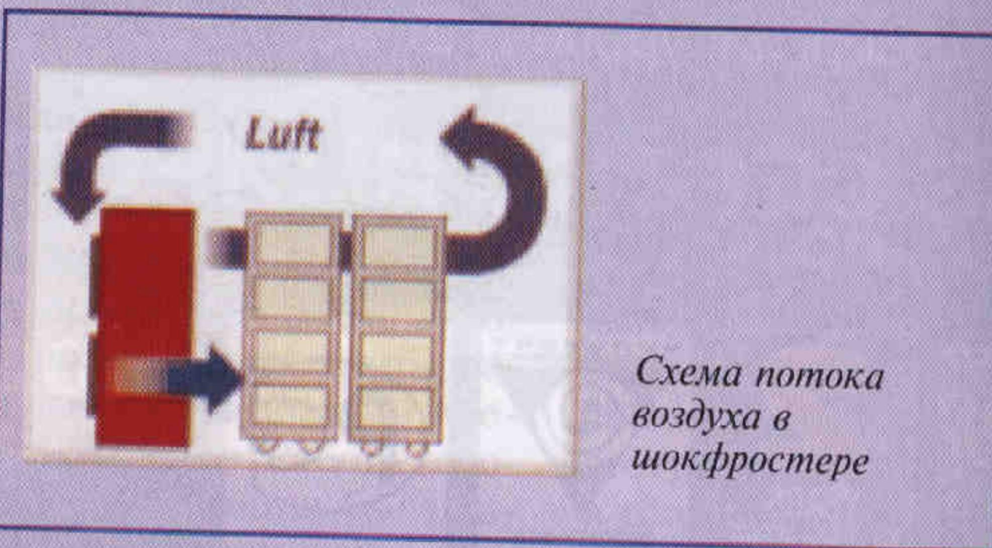
При установке шокфростера в морозильной камере расстояние его от стеки камеры должно быть достаточным для всасывания отработанного воздуха, а также для технического обслуживания. Поток воздуха направляется через шокфростер над фальш-потолком к замораживаемому продукту и затем возвращается в шокфростер.
