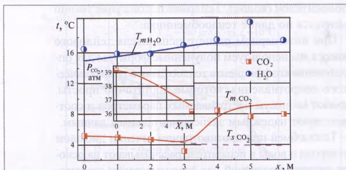
Рис. 9. Сопоставление результатов расчета температур  $\text{CO}_2$  и  $\text{H}_2\text{O}$  и давления  $\text{CO}_2$  по длине испарителя (кривая) с экспериментом авторов (точки)
