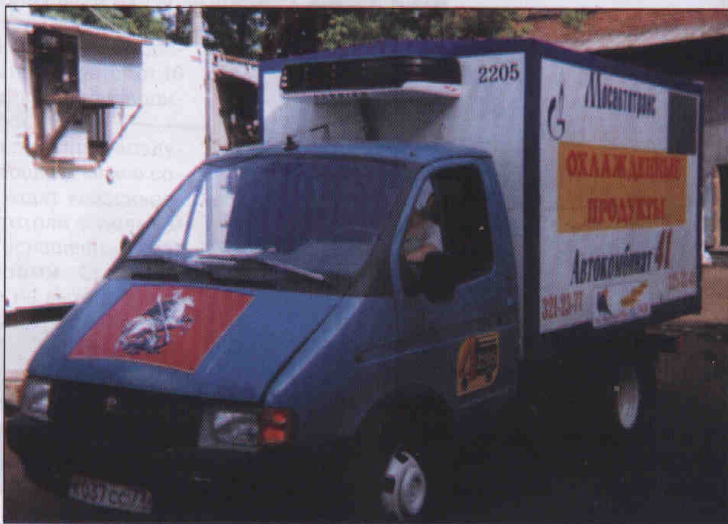
Компактный холодильный агрегат "Зефир 30S" на шасси автомобиля "Газель"
