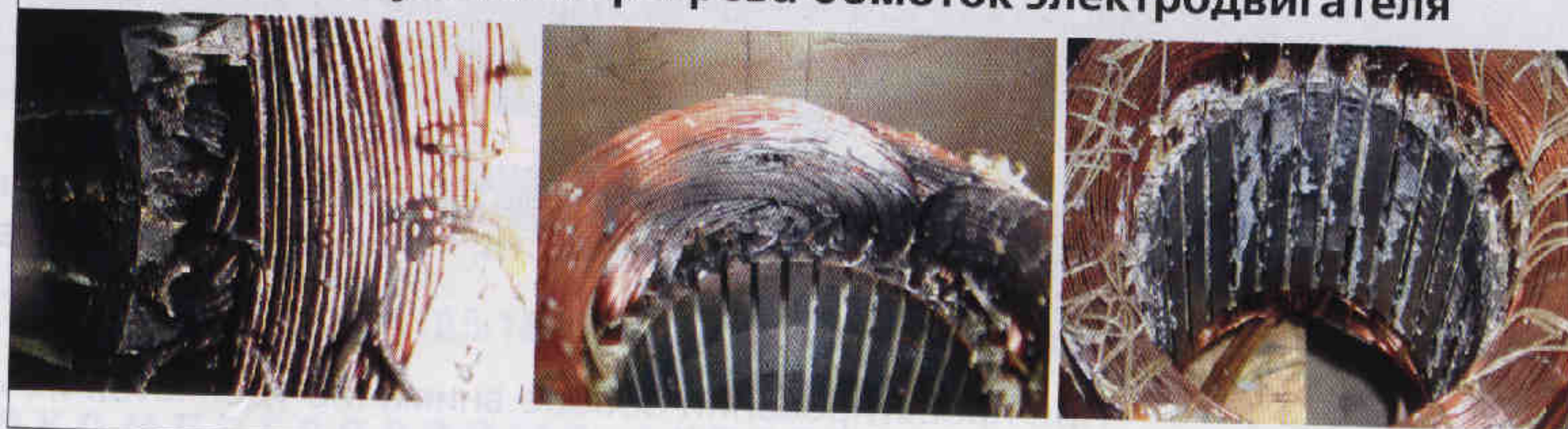
Рис. 5. Результат перегрева обмоток электродвигателя
