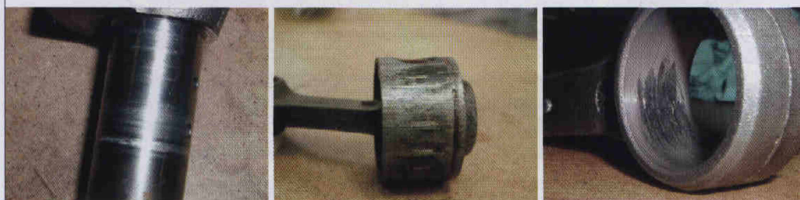
Рис. 3. Последствия, вызванные недостатком масла
