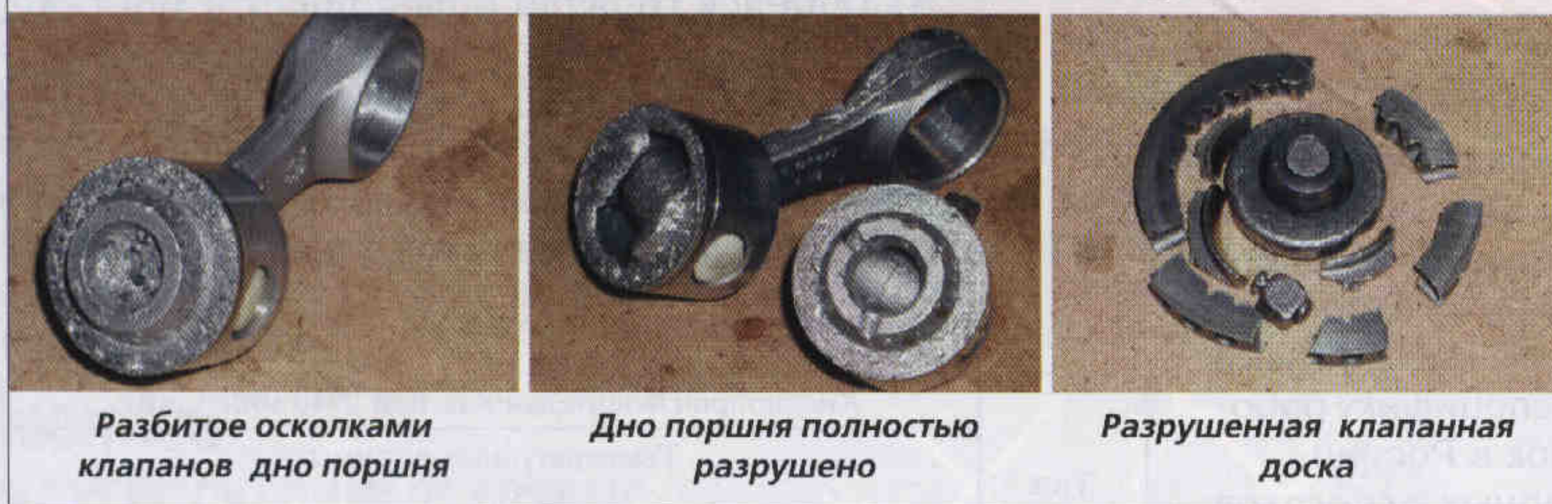
Рис. 1. Последствия гидравлического удара
