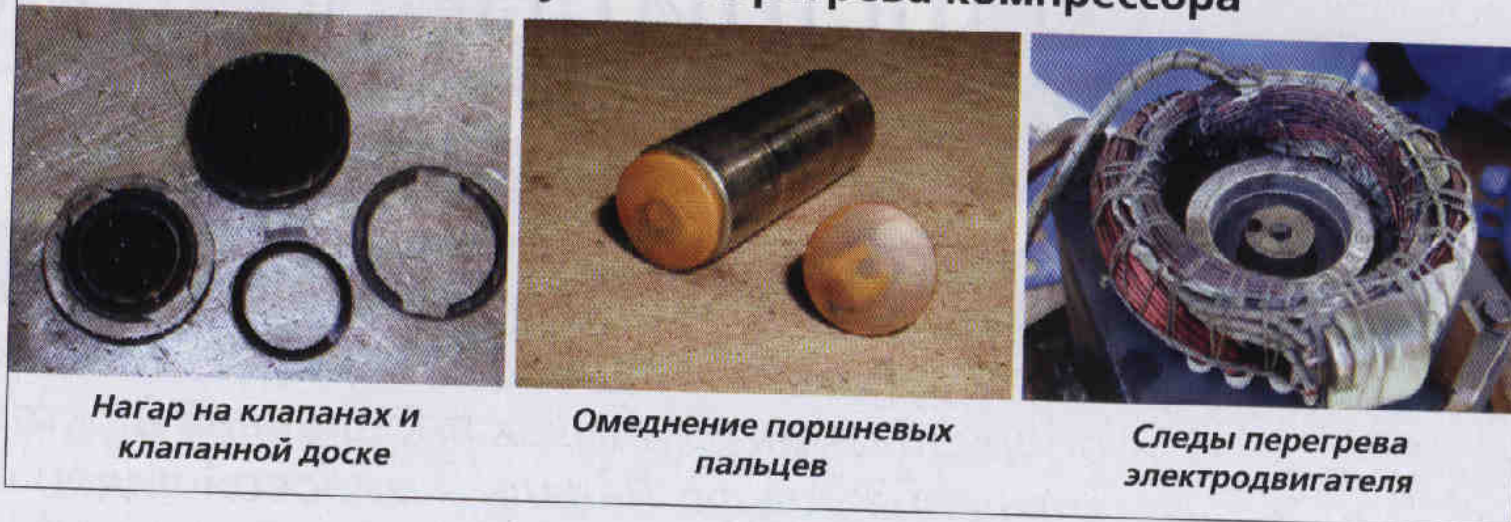
Рис. 5. Результат перегрева обмоток электродвигателя
