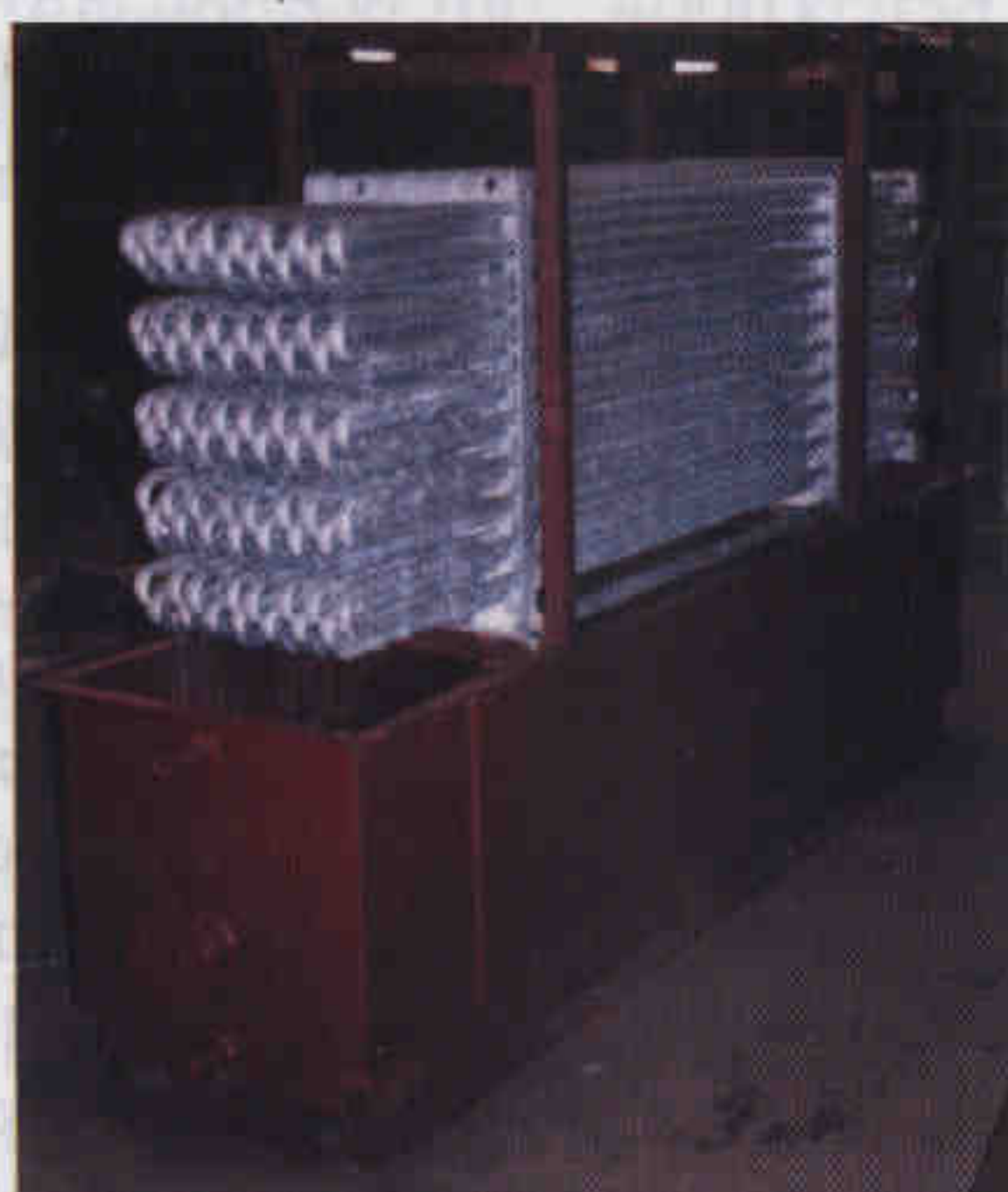
Оцинкованный теплообменный пучок БИТ-25
