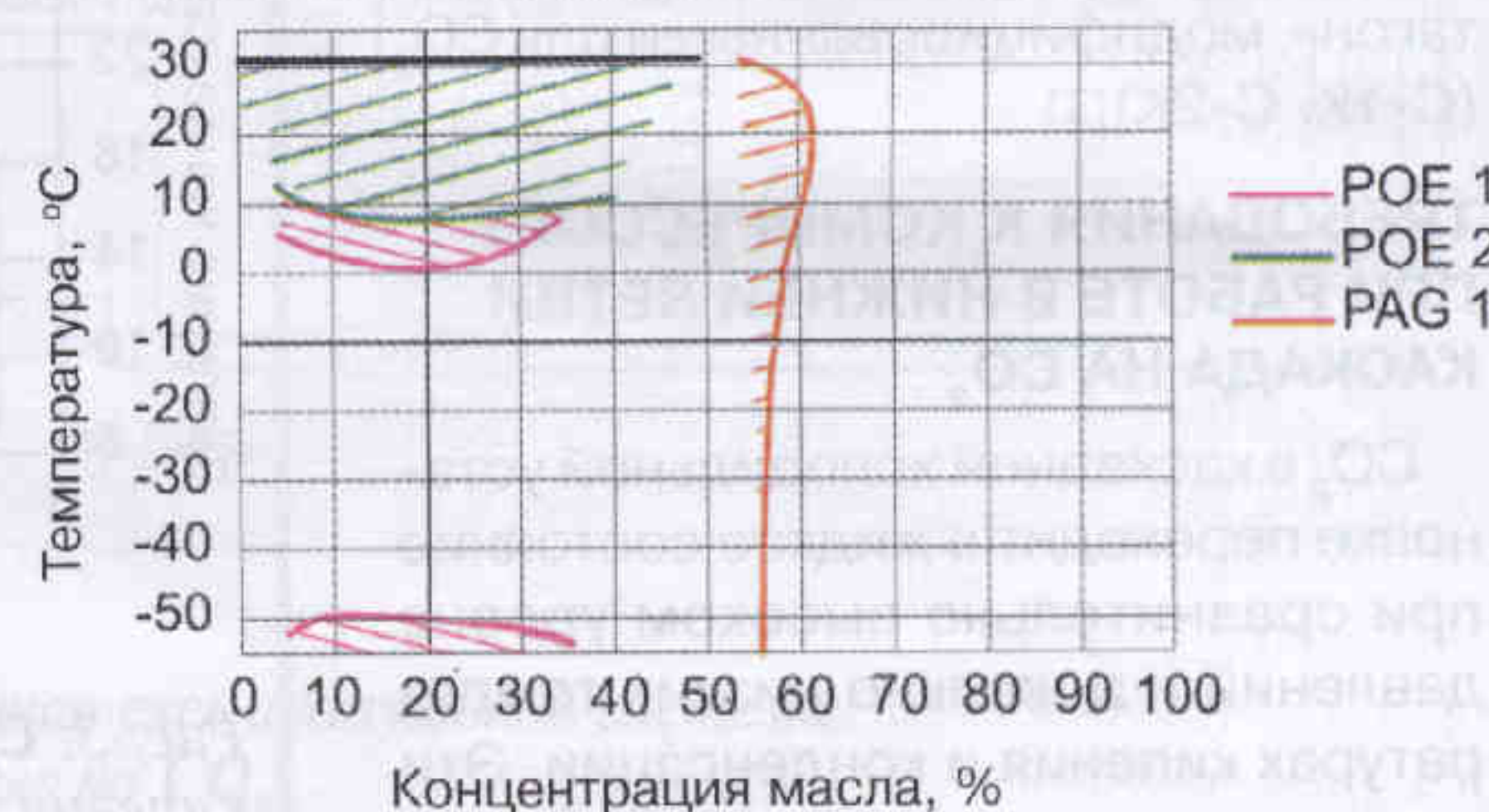
Рис. 9. Границы смешиваемости \text{CO}_2 с РОЕ-маслами и PAG-маслом при докритических температурах
