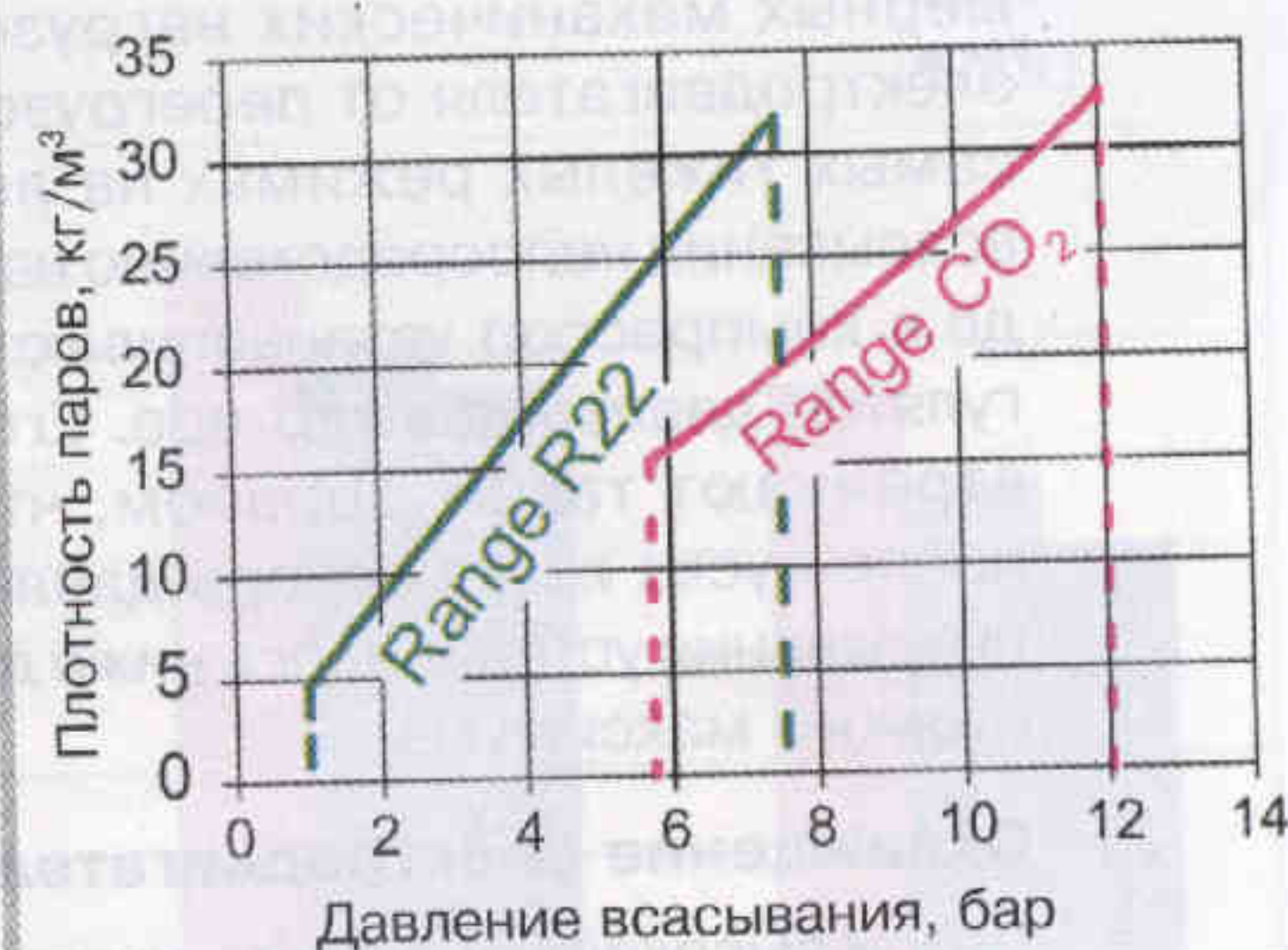
Рис. 4. Сравнение значений плотности паров в пределах стандартных диапазонов давлений всасывания для \text{CO}_2 и R22
