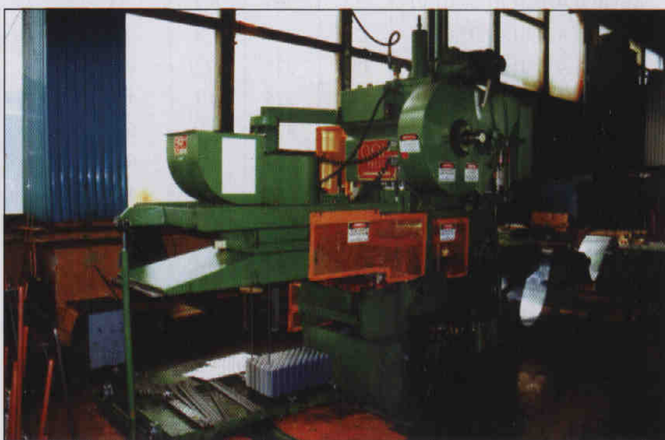
Рис. 2. Пресс для штамповки теплообменных пластин на заводе «ВЕЗА» (г. Фрязино)
