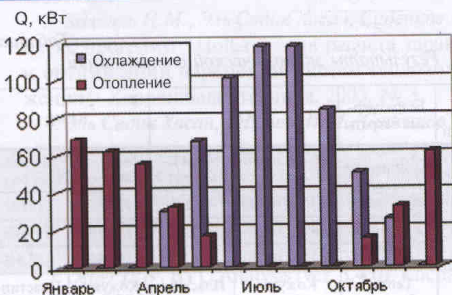
Рис. 1. Расчетная диаграмма годового тепло-холодотребления жилого дома
