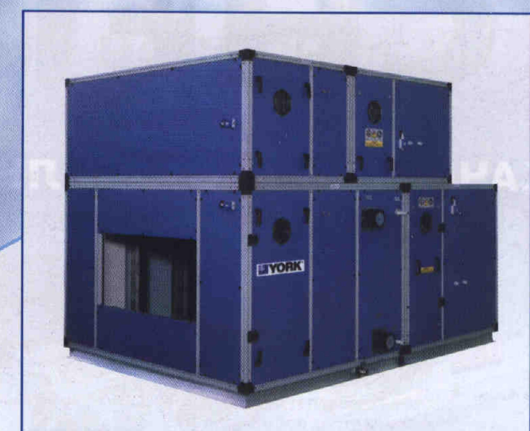
корпуса толщиной 30 или 60 мм изготовлены из оцинкованной стали с пенополиуретановым наполнением, что обеспечивает хорошую теплоизоляцию и механическую прочность. По желанию заказчика могут быть поставлены стальные окрашенные или пластифицированные панели, панели из нержавеющей стали или из алюминиевого сплава. Двери и люки облегчают доступ к элементам установки, требующим регулярного технического обслуживания и проверки. Любая панель при необходимости может быть легко демонтирована.
