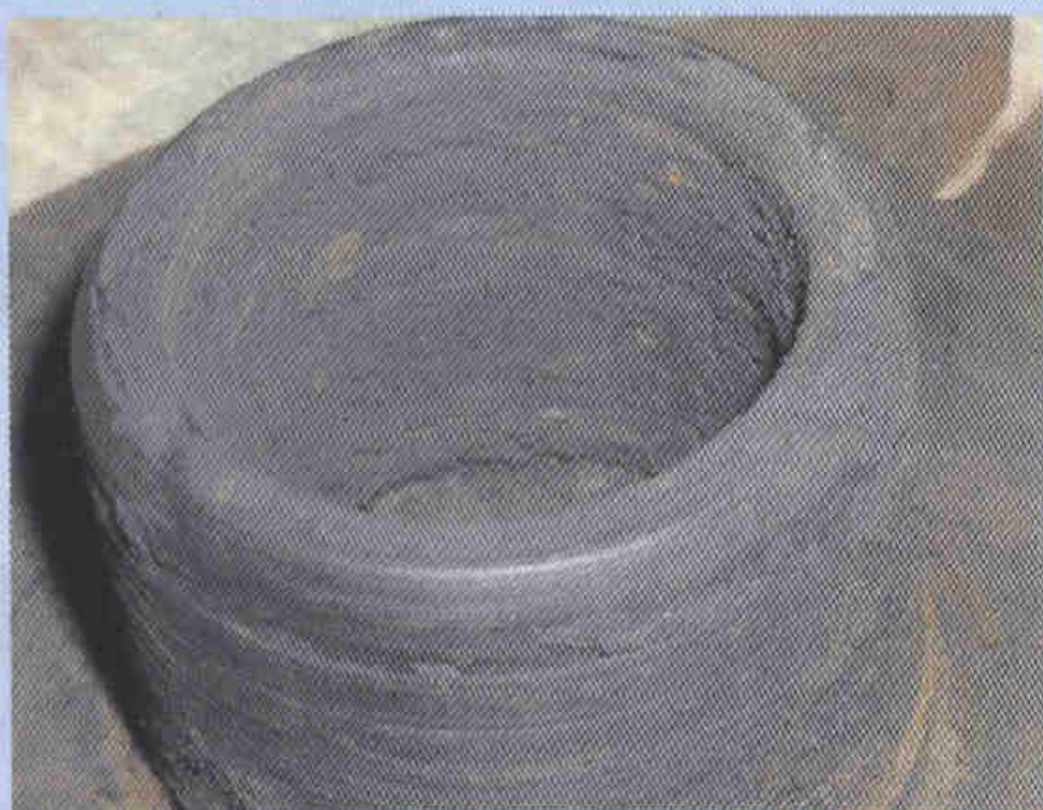
Рис. 3. Разрушенный упорный подшипник подвижной спирали
