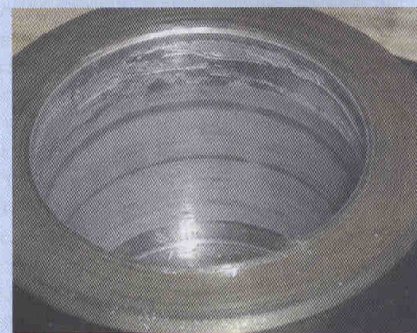
Рис. 5. Повреждения деталей спирального компрессора из-за плохой смазки:
