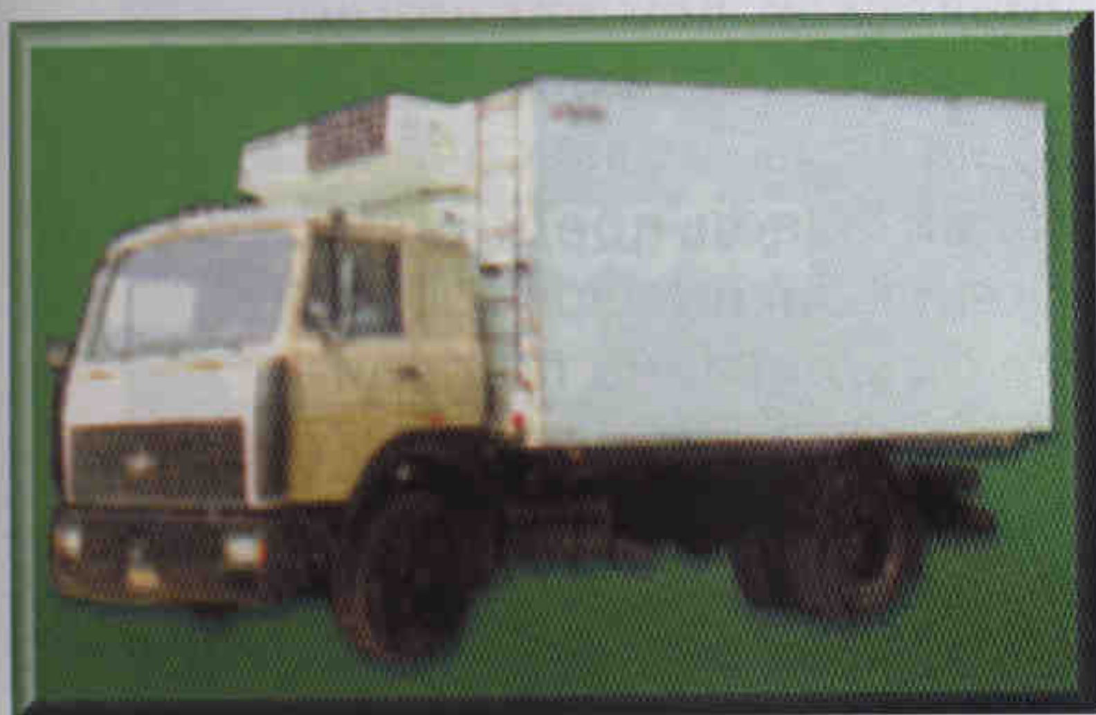
Рис. 2. МАЗ 53363/53366, КИ 6226, серия «Супер-люкс», внутренние размеры 6,1×2,4×2,4 м; грузоподъемность 7000 кг; объем 35,6 м³; масса кузова 1700 кг.
