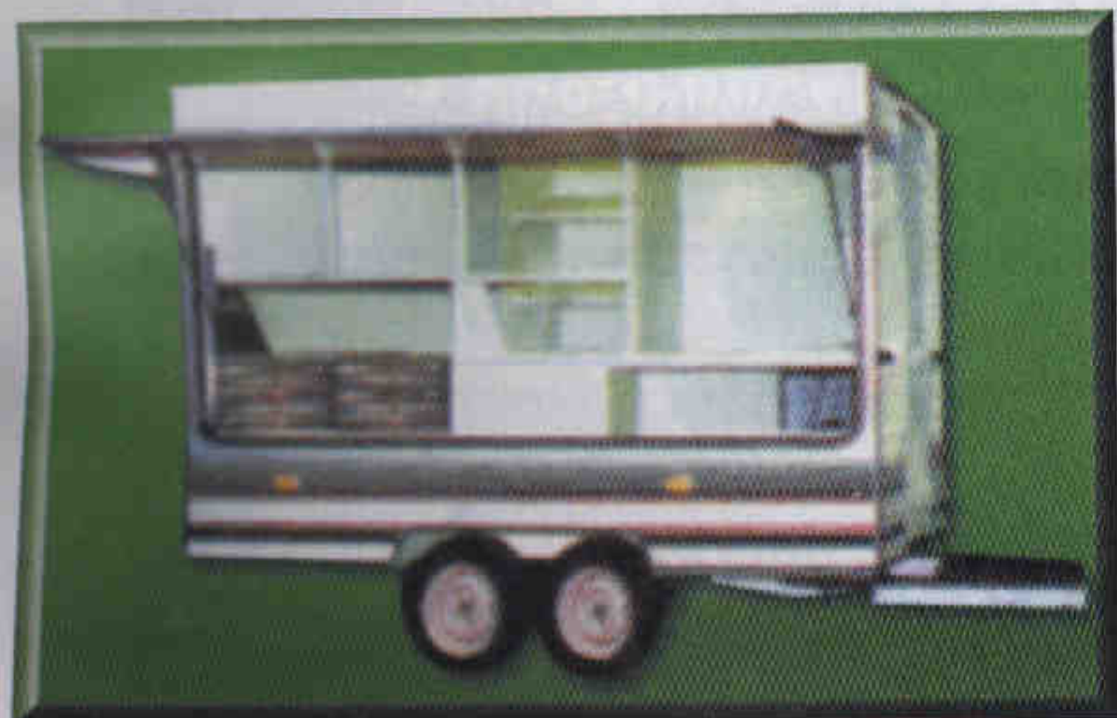
Рис. 3. Торговый прицеп: одна ставня, мебель из ламинированной ДСП, одна холодильная витрина, освещение 12 В/220 В. Внутренние размеры 3,2×2,0 × 2,0 м
