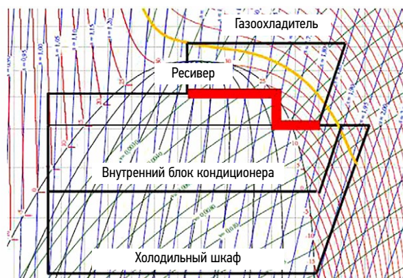
Рис. 12. Диаграмма logP-h без теплового накопителя и с ним. Fig. 12. LogP-h diagram without and with thermal storage.
