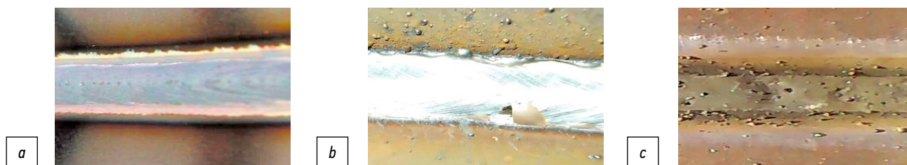
Рис. 2. Шлифы паяных швов листовой стали марки ХН70ВМТЮ с использованием различных припоев. а) припой ПСр8КЦН; б) припой марки Cd-5Ag; в) припой марки Pb-Ag 2,5 -Cu.
