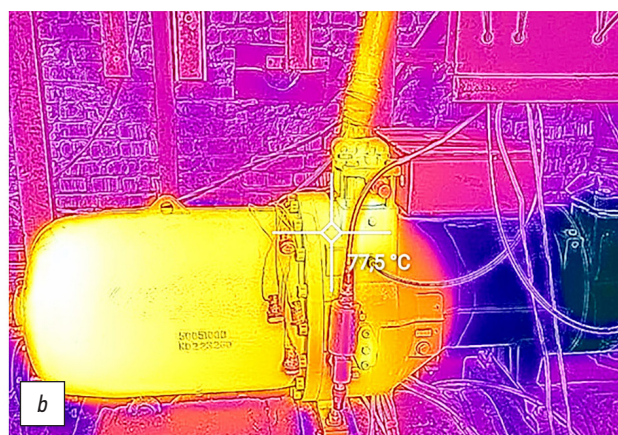
Рис. 1. Тепловизионная съёмка компрессоров: a — контур 2 (норма); b — контур 1 (повышенная температура нагнетания). Fig. 1. Thermal imaging of compressors: a , contour 2 (normal); b , contour 1 (elevated discharge temperature).
