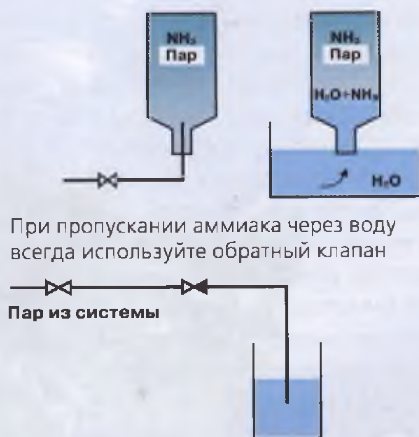
Рис. 1. Эксперимент с колбой, демонстрирующий структурную близость аммиака и воды
