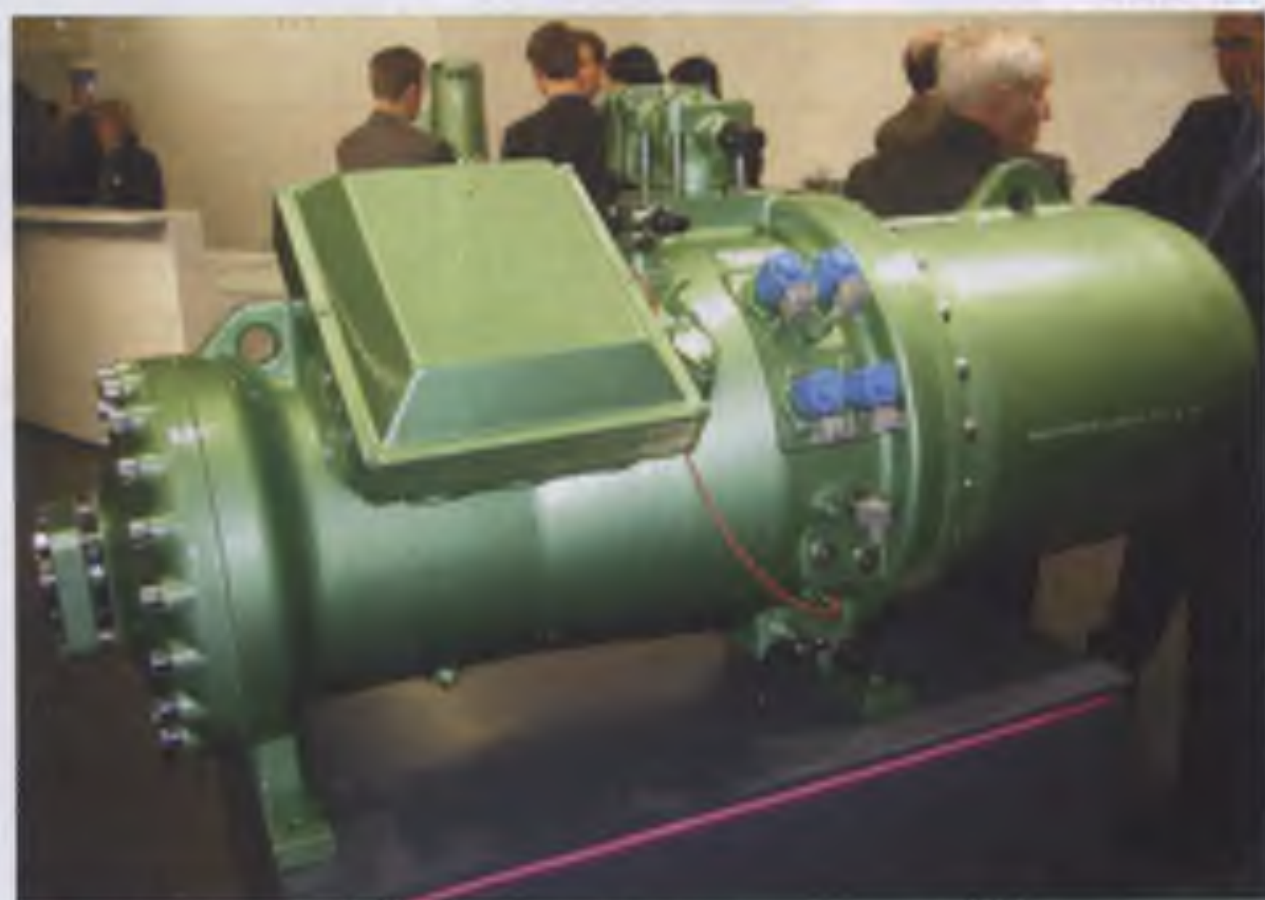
Рис. 1. Компактный винтовой компрессор CSH 9591-300Y, демонстрировавшийся на выставке ИКК-2004
