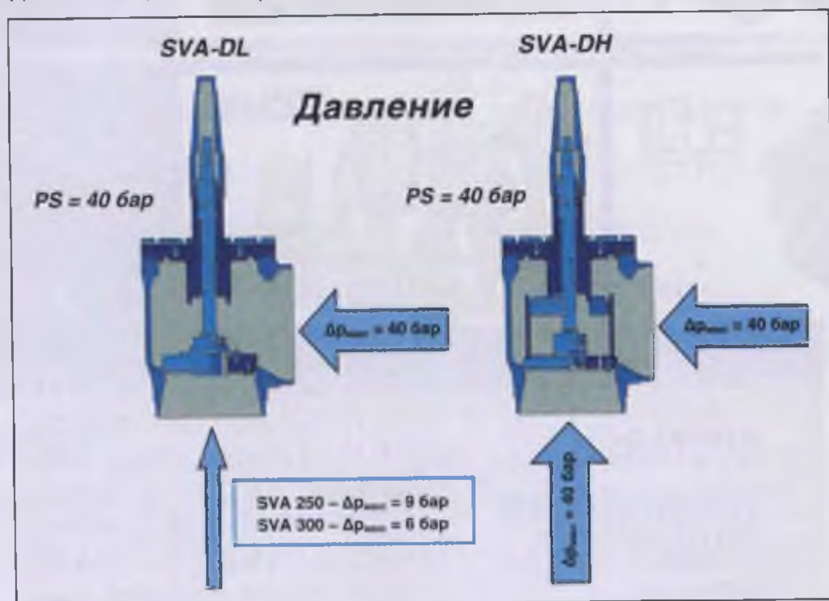
Рис. 6. Запорные вентили SVA-DL и SVA-DH
