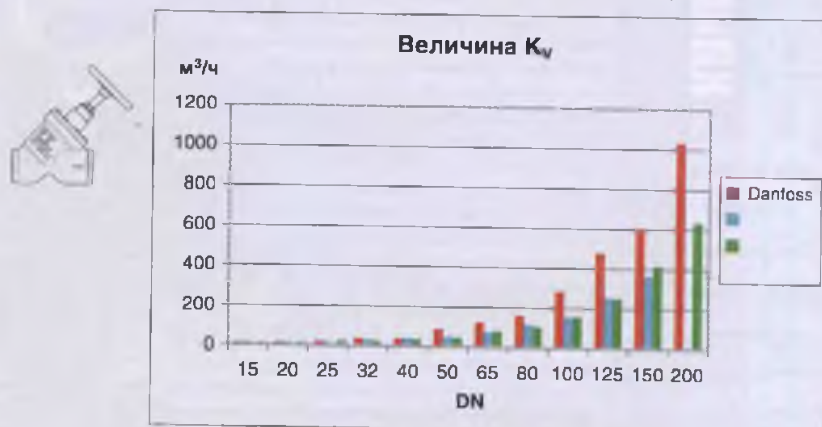
Рис. 3. Сравнение величины K_v для угловых запорных вентилей
