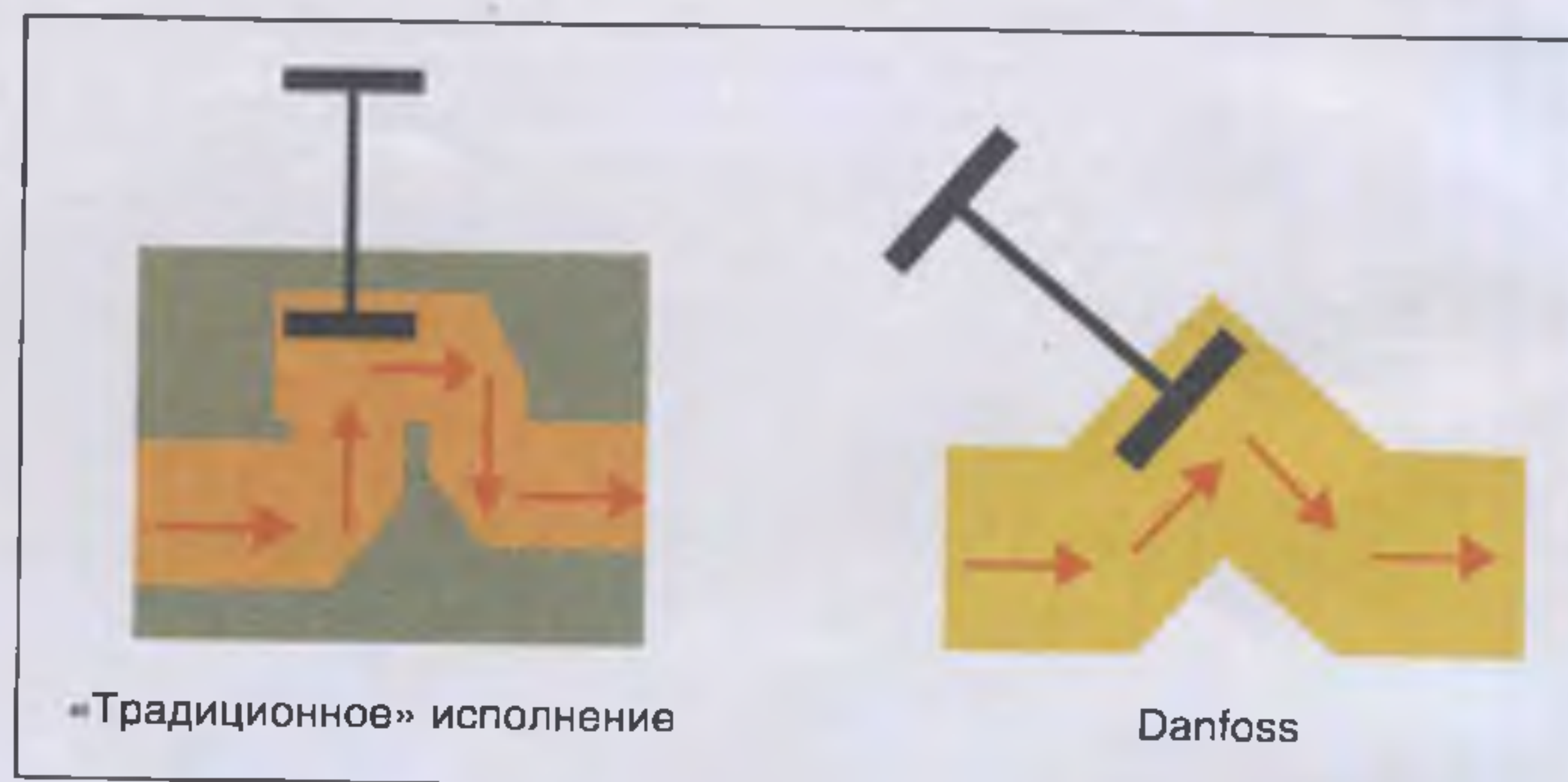
Рис. 5. Конструкции проходных запорных вентилей
