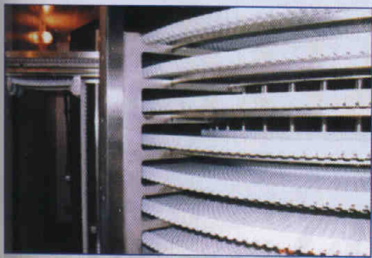
Спиральный конвейер скороморозильного аппарата производительностью 350 кг/ч
