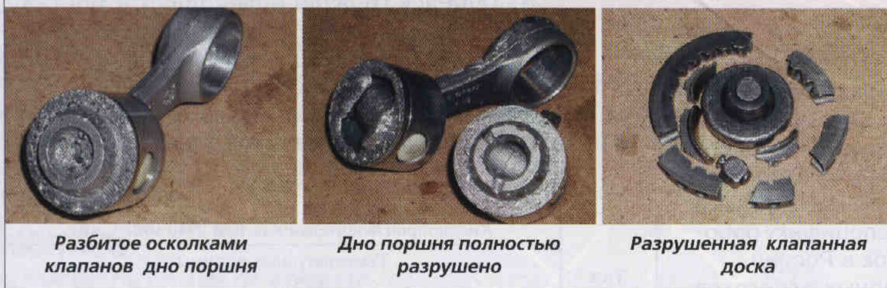
Рис. 1. Последствия гидравлического удара
