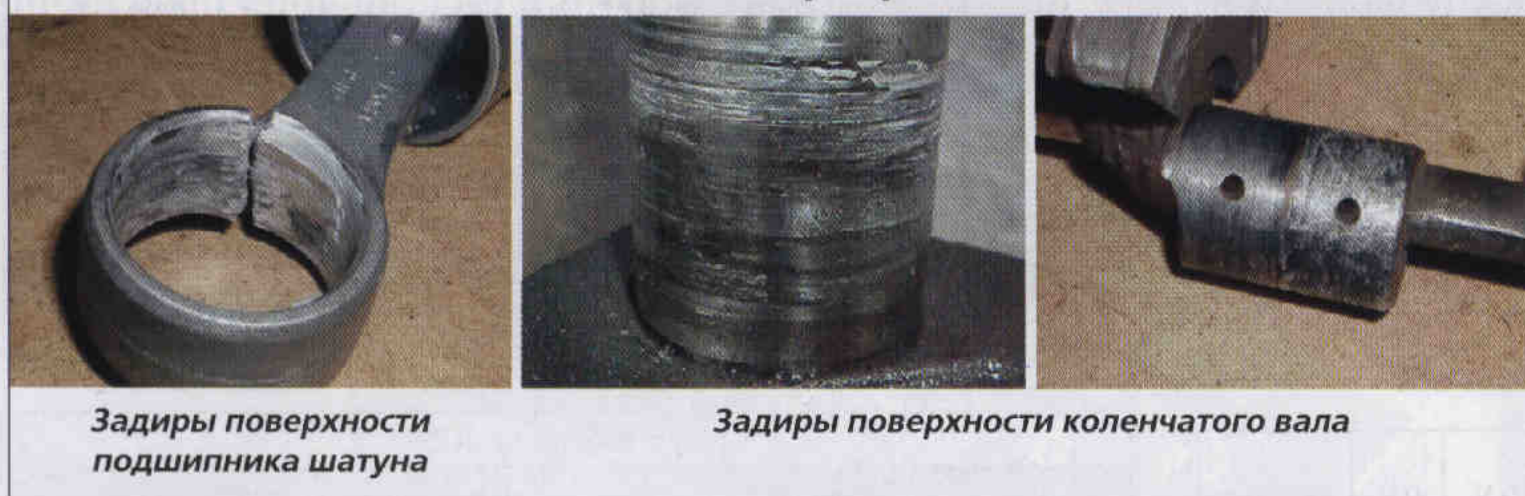
Рис. 2. Последствия, вызванные растворением хладагента в масле в картере КМ
