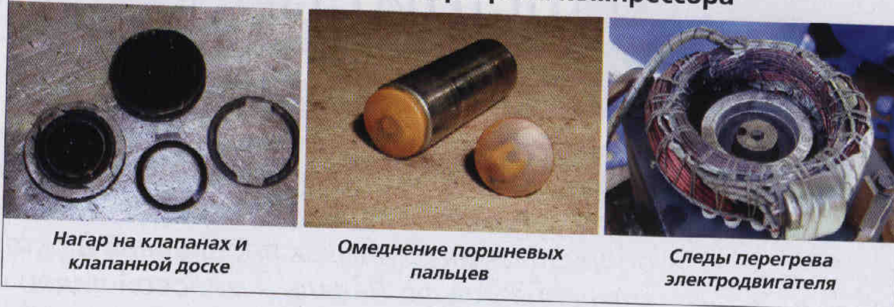
Рис. 5. Результат перегрева обмоток электродвигателя
