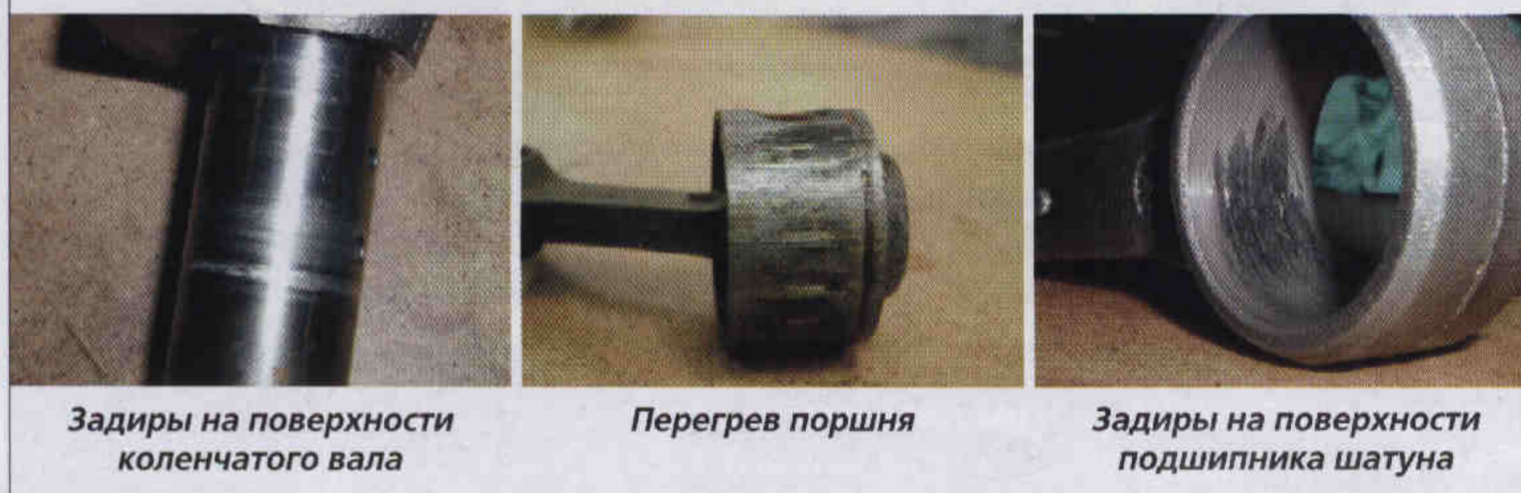
Рис. 3. Последствия, вызванные недостатком масла
