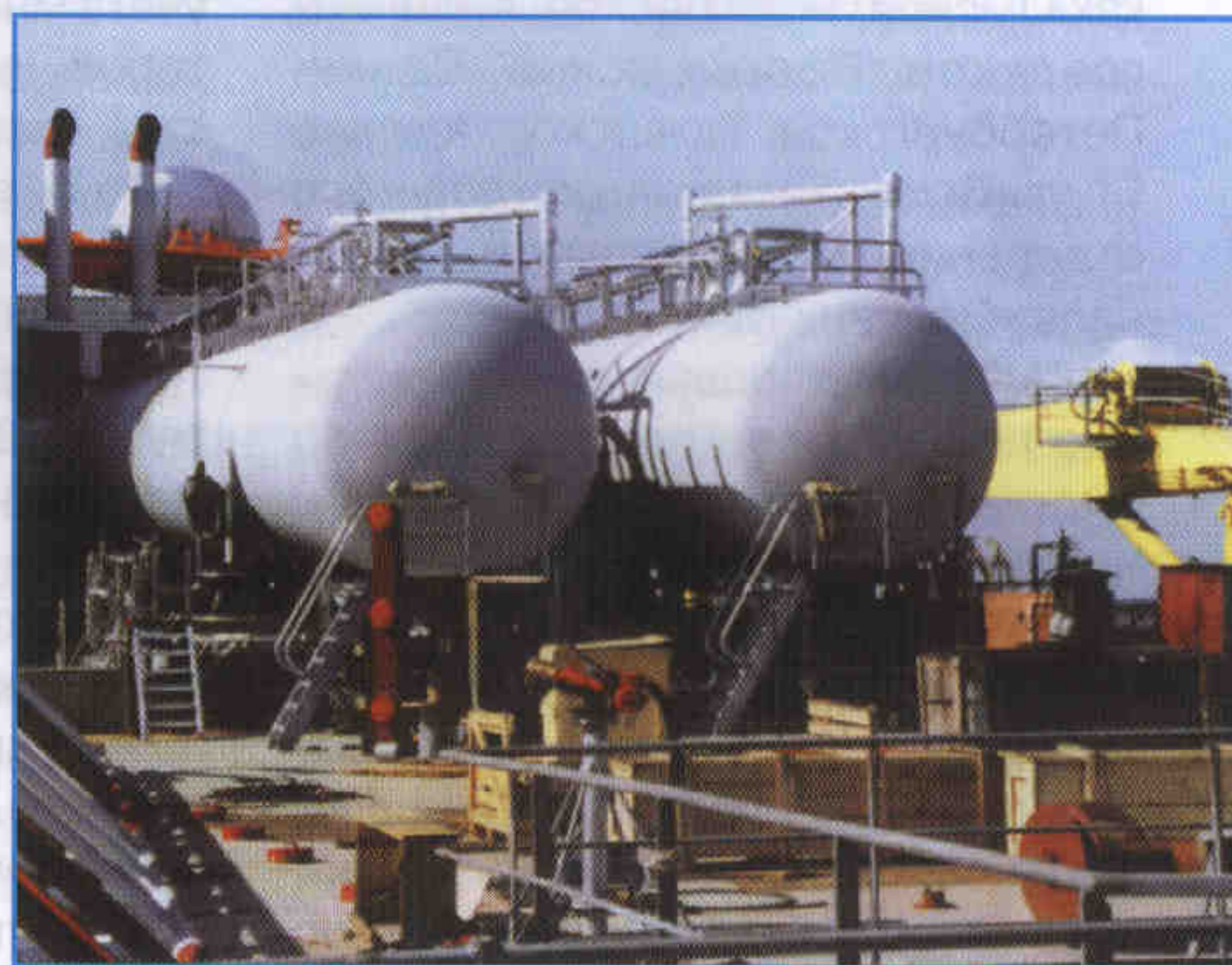
Рис.1. Система заправки кислородом для международного стартового комплекса морского базирования (ОАО «Криогенмаш»)
