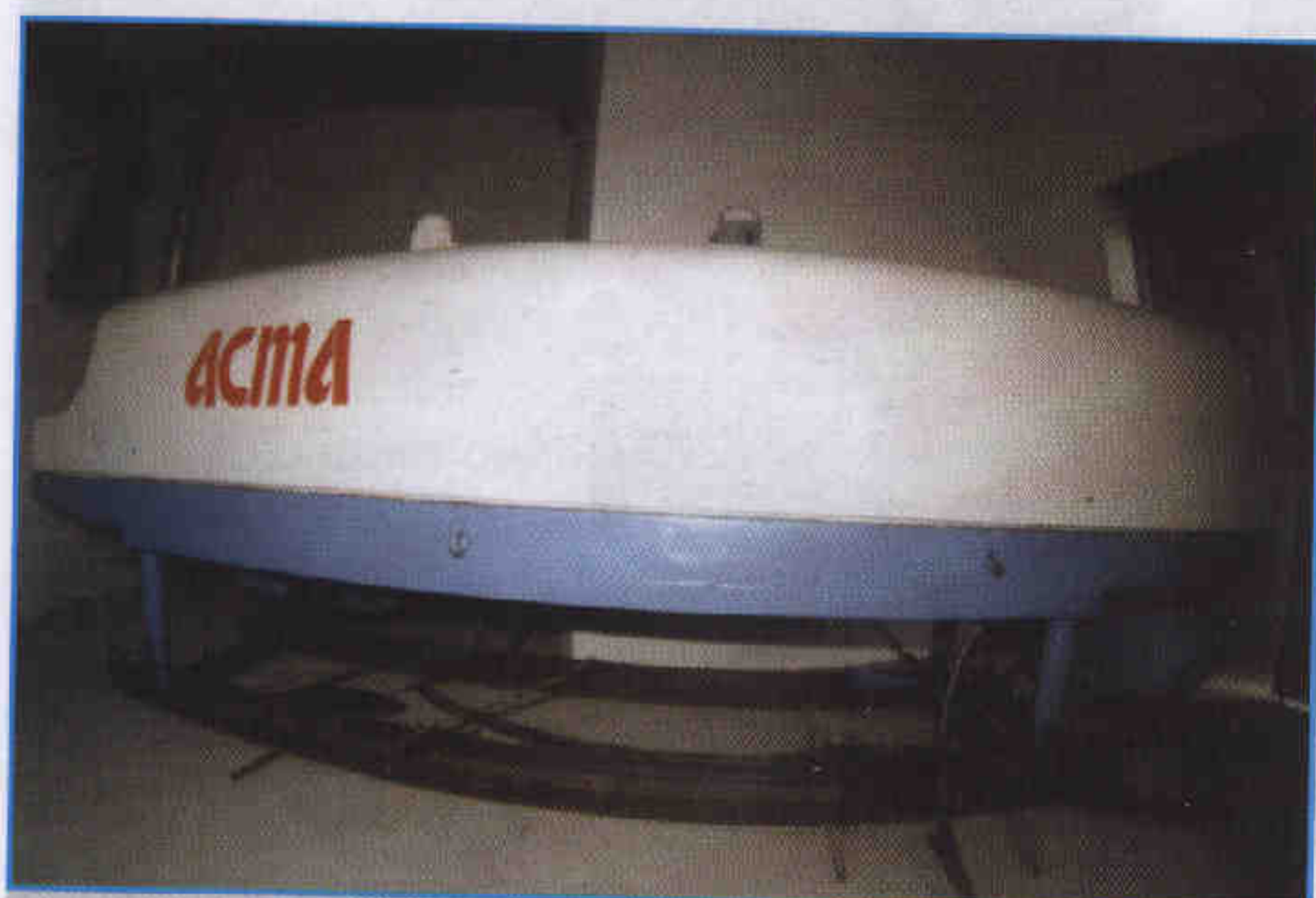
Рис. 13. Азотный туннельный скороморозильный аппарат АСТА-30
