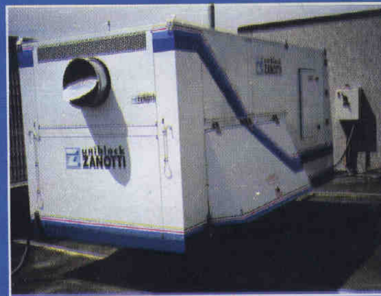
Передвижная холодильно-нагревательная машина с использованием тепла конденсации – моноблок для сушки зерна и травы
