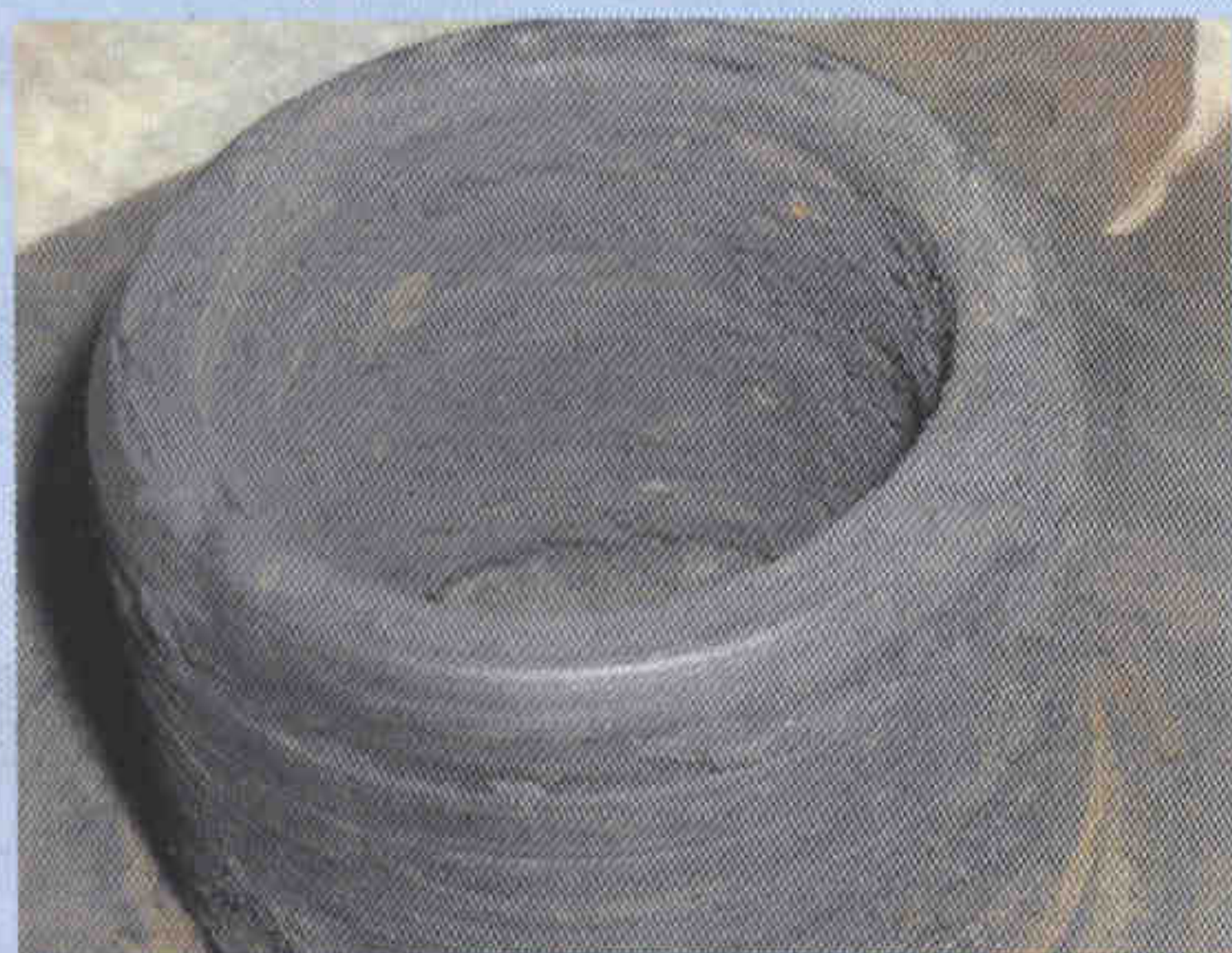
Рис. 3. Разрушенный упорный подшипник подвижной спирали
