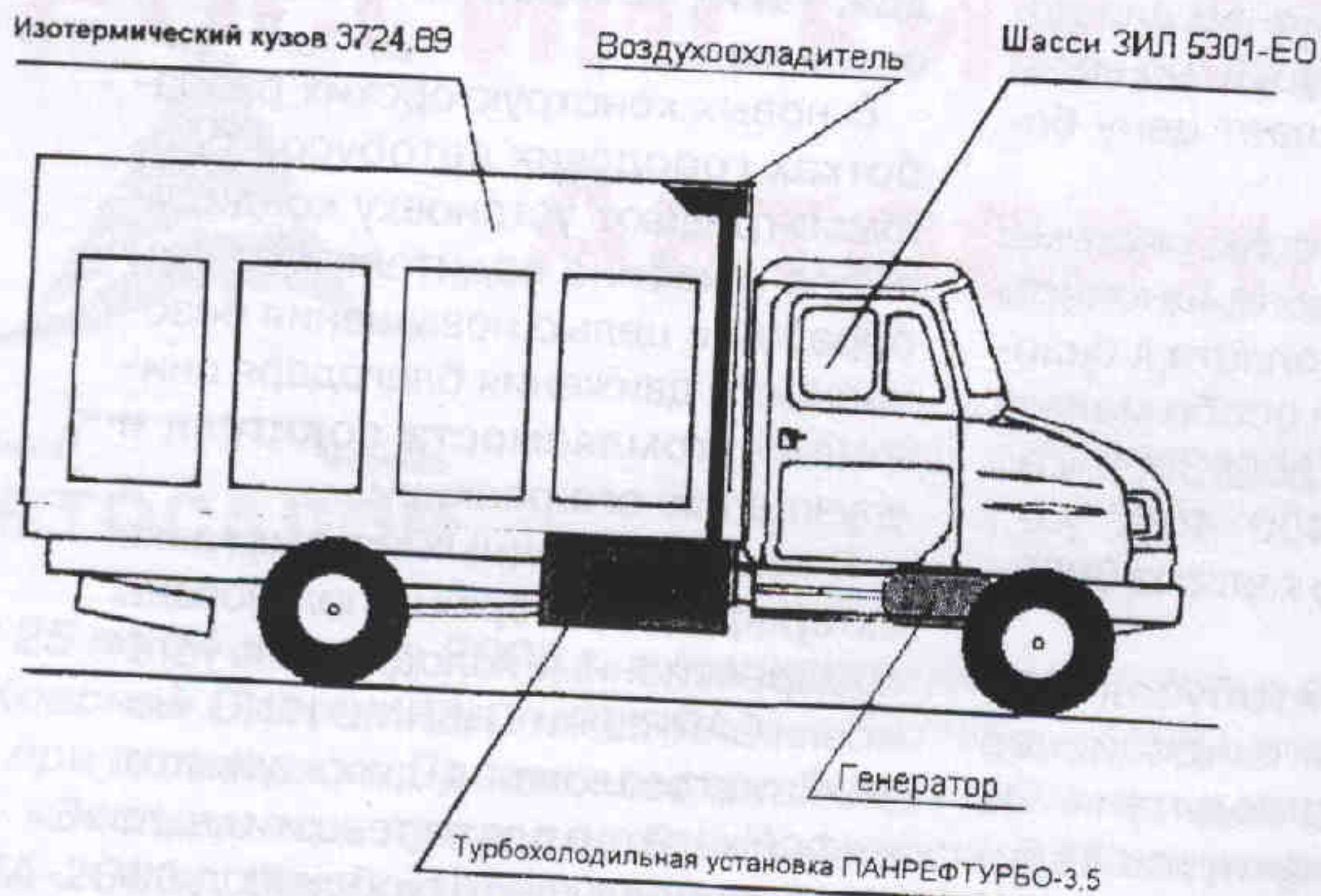
Рис. 2. Схема размещения турбохолодильной установки «ПАНРЕФТУРБО» на шасси автомобиля ЗИЛ-5301
