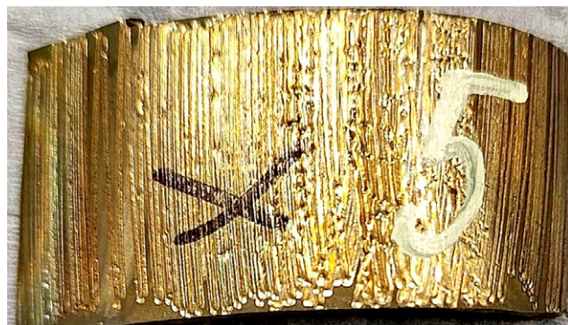
Рис. 6. Образец с неравномерностью очищения.
