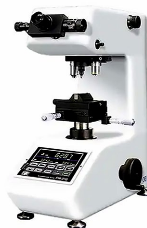
Рис. 4. Микротвердомер Future Tech FM-31.
