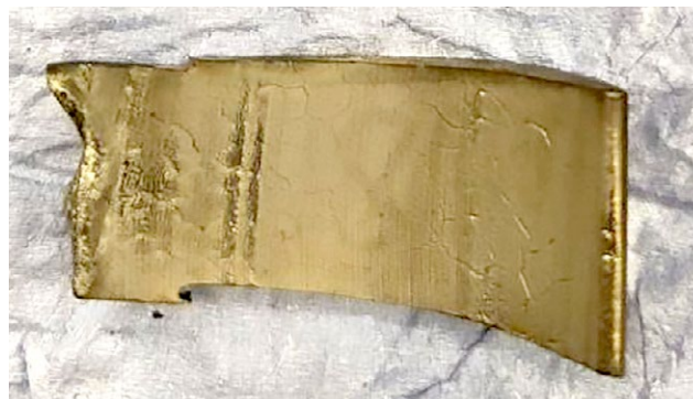
Рис. 7. Образец с трещинами и проплавлениями.
