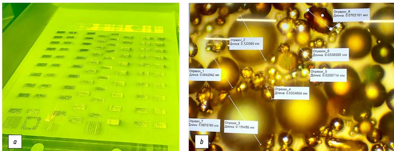
**Рис. 3.** Внешний вид платформы (а) и порошинки после воздействия лазерного излучения, удаленные из ванны расплава (б).
