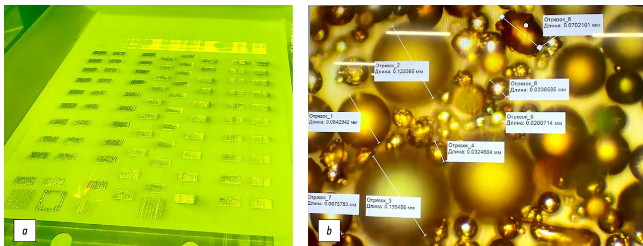
Рис. 3. Внешний вид платформы (а) и порошинки после воздействия лазерного излучения, удаленные из ванны расплава (б). Fig. 3. View of the platform (а) and powder particles removed from the melt bath after exposure to laser radiation (б).
